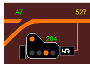
Signal 204 sur le TCO avec aiguillage 7 dévié
