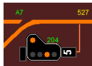
Signal 204 sur le TCO avec aiguillage 7 dévié
