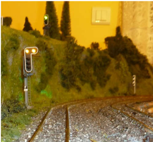
Signal de ralentissement sur un réseau piloté par CDM Rail + programme client. Il annonce un aiguillage distant pris en pointe dévié à franchir à 30 km/h. Ce signal sera suivi d'un signal de rappel de ralentissement 30 km/h (deux feux jaunes verticaux) placé avant l'aiguille.
