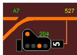
Signal 204 sur le TCO avec aiguillage 7 dévié
